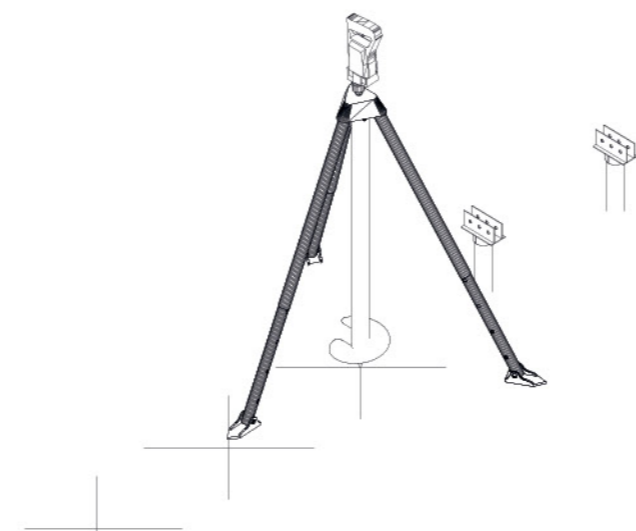
NAVŔTANIE ZEMNÝCH VRUTOV NA VYMERANÉ MIESTA, POLOŽENIE A VYROVNANIE OCELOVÝCH SPOJK.
