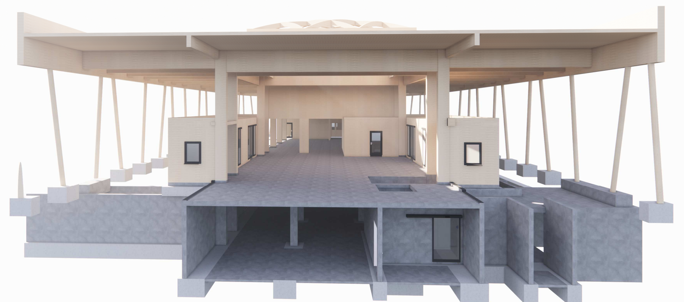
PRIEČNY REZ NOSNÝM SYSTÉMOM ŽELEZNIČNEJ STANICE
